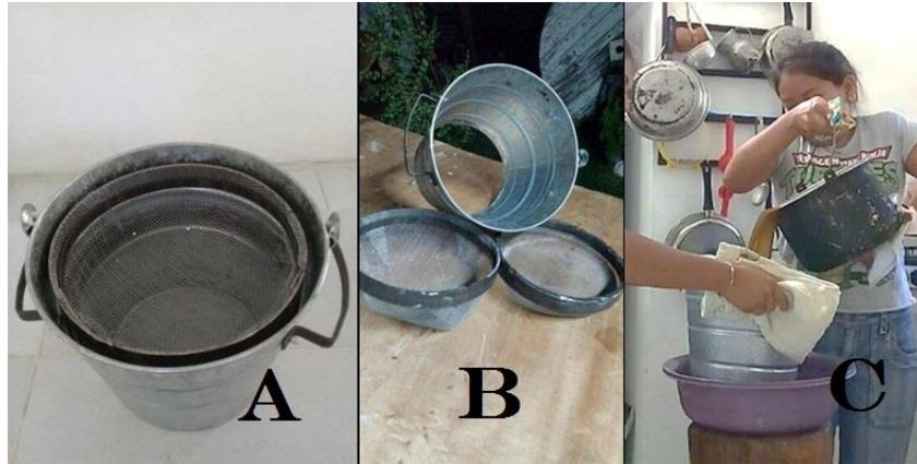
Figura 3. (A) Colador para cera elaborado con una cubeta de lámina galvanizada y sus filtros; (B) Partes separadas del colador; (C) Colado de cera fundida. Los estudiantes que elaboraron el colador asesorados por los maestros fueron: Lucía del Rosario Cen Cutz; Michelle Curiel Cordero; Royer José Hernández García; Yadzareth Larios Trejo y Saraf Macario Esparza.
