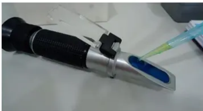
Figura 3 . Refractómetro de proteína sérica (tomado de Miqueo y Relling 2017).
