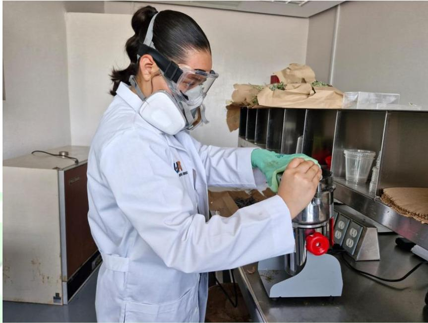
Figura 2. Tratamiento del material seco en el molino de cuchillas.
